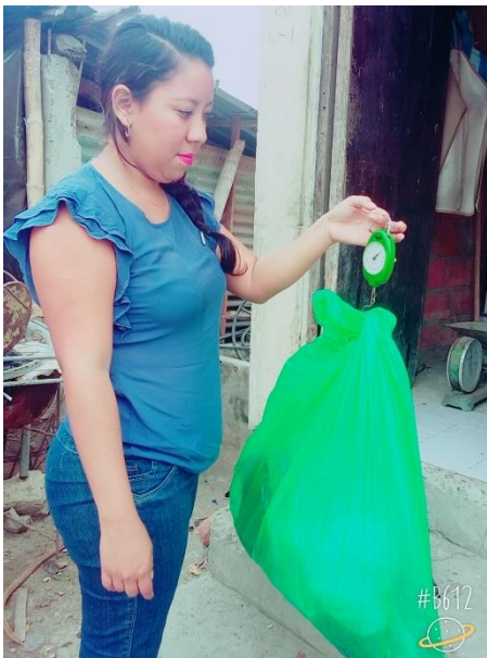
Foto 5. Análisis de peso específico de los residuos sólidos
