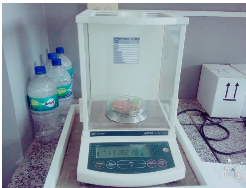
Foto 11. Peso de la caga Petri con la muestra de los residuo sólido
