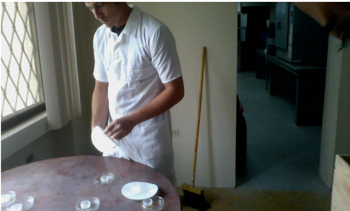
Colocación de los papeles filtro en las cajas Petri
