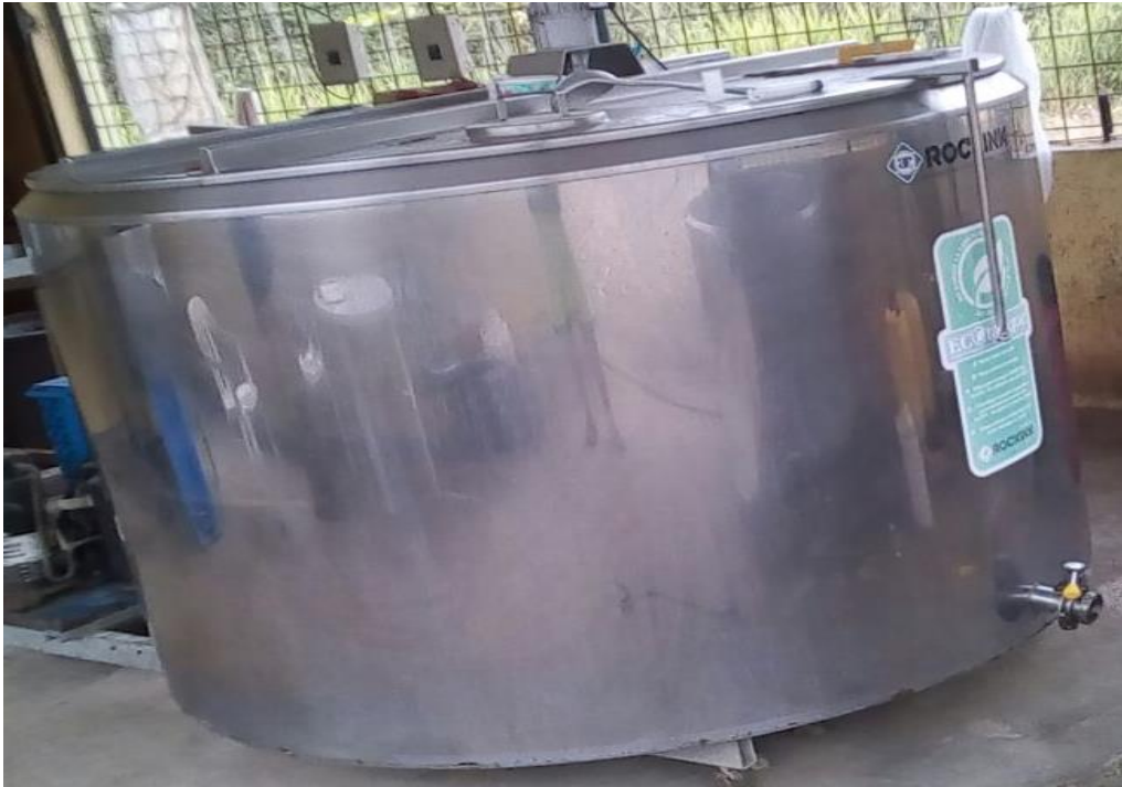
Anexo 15. Tanque de refrigeración
