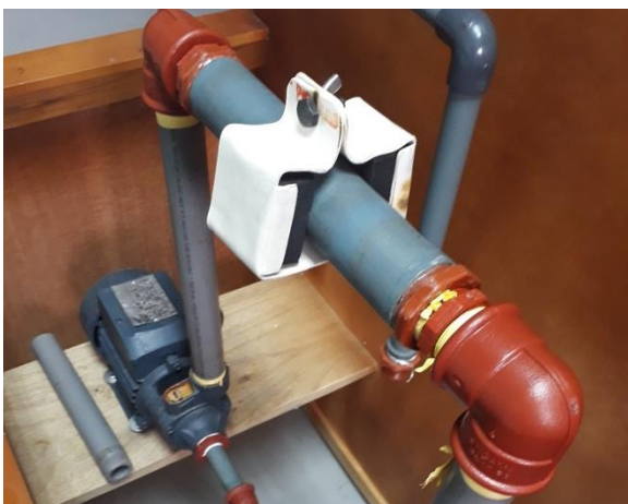
Anexo 1. Prototipo del sistema magnético con tubería de PVC.
