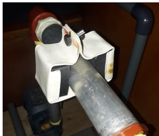
Anexo 2. Prototipo del sistema magnético con tubería de aluminio.
