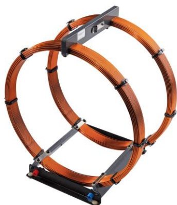
Grafica 3.1 Modelo de la bobina de Helmholtz, con su respectivo transformador. Diseñada y construida por los autores de esta investigación.
