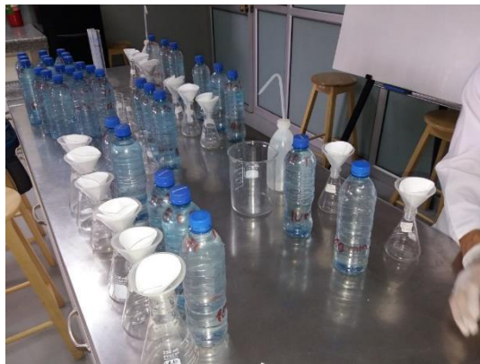
Anexo 1F. Filtración de muestras de agua
