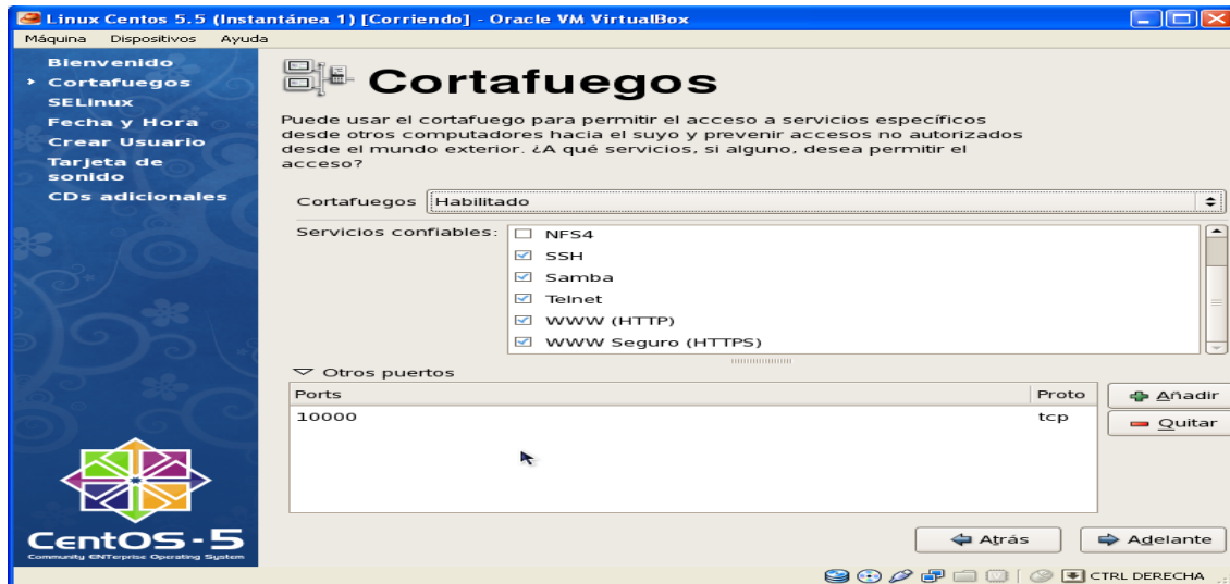
Figura 3.6. Activación de los cortafuegos de Linux
