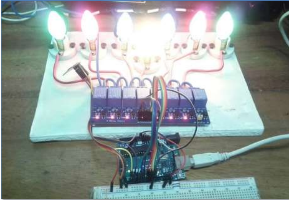
Figura 4.8. Comunicación del Dispositivo Arduino con el Módulo Relé 110v Fuente: Autores
