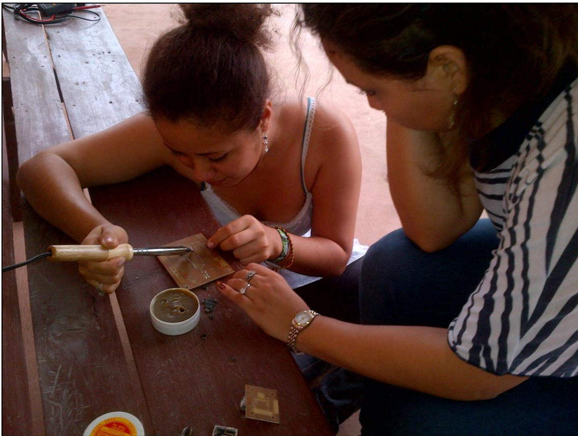
Instalación de los componentes del circuito principal.
