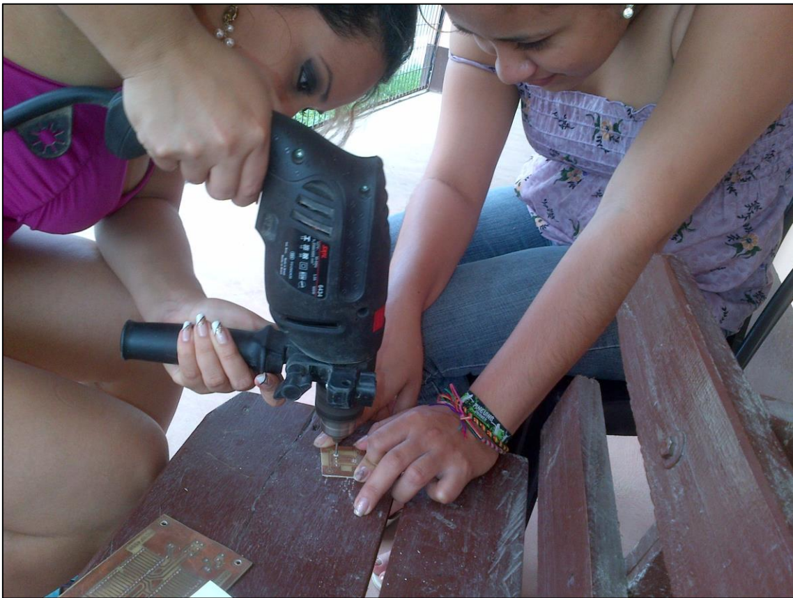
Perforación de la placa principal del sistema de riego automatizado.
