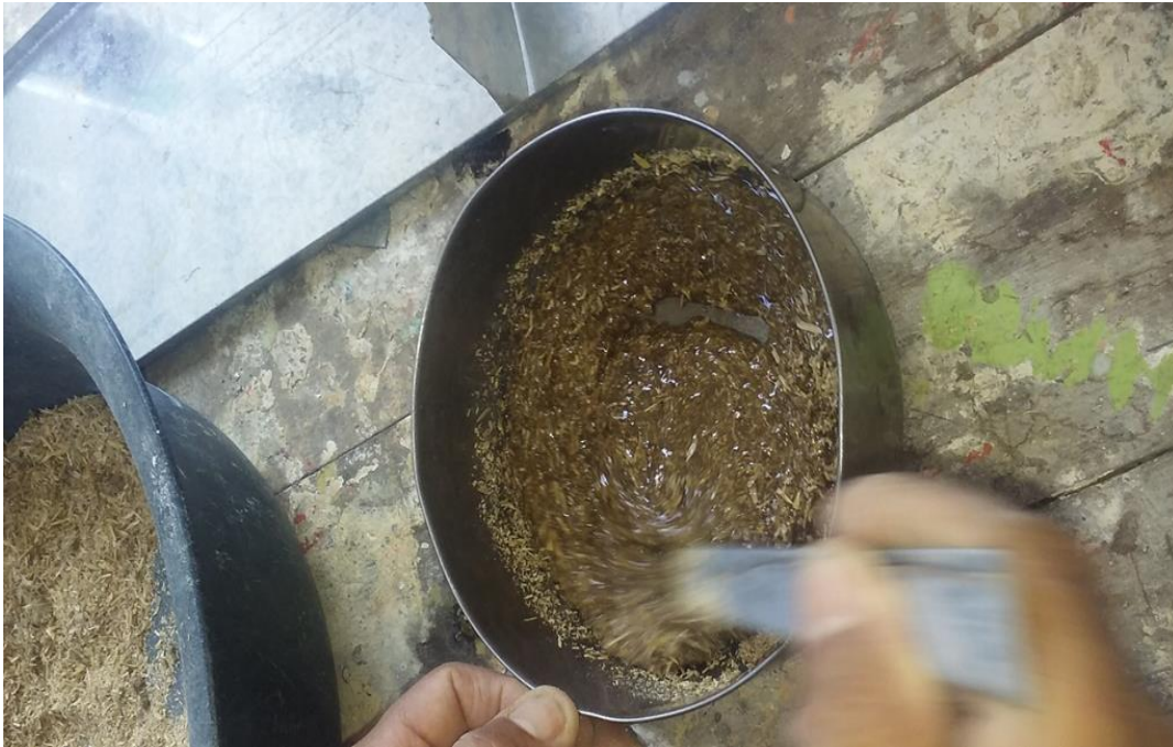
Anexo 11. Mezclado de los residuos con el pegamento.
