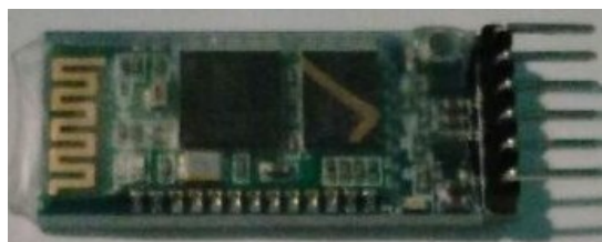
Figura 3.3. Modulo Bluetooth HC-05
