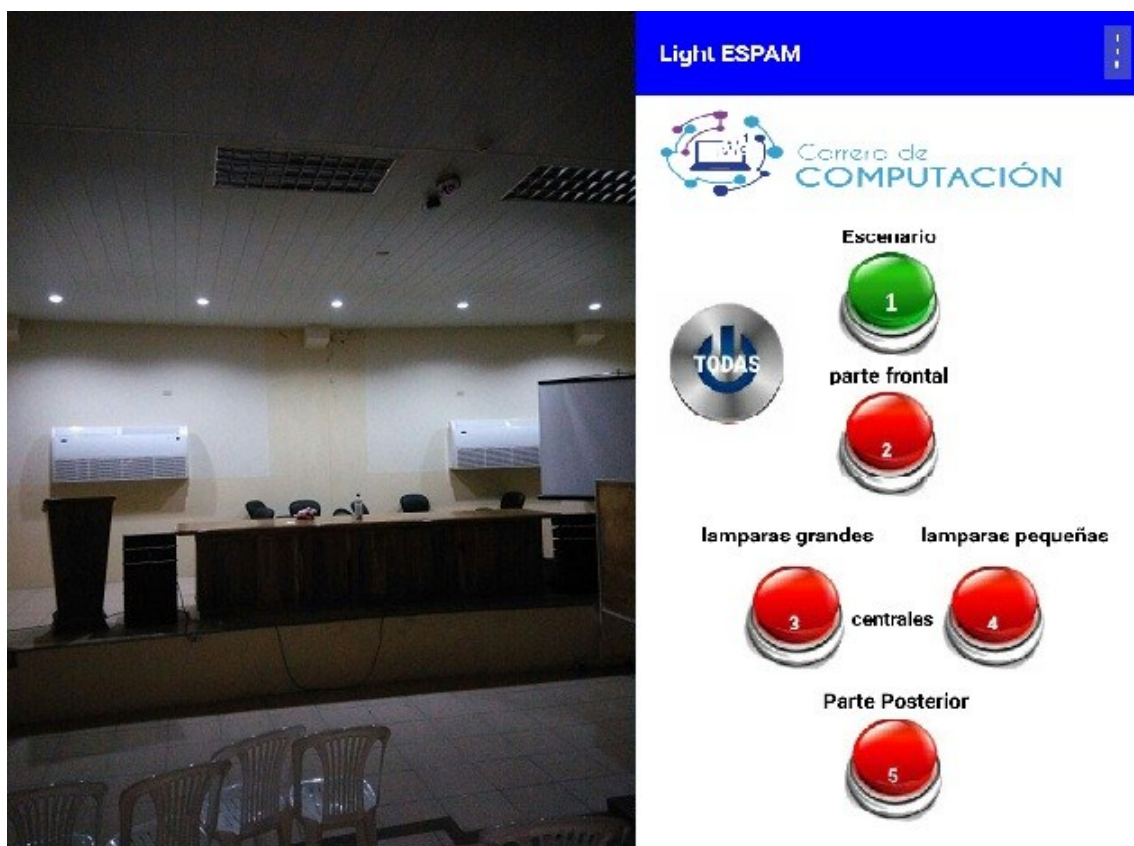
Figura 4.6. Prueba de Encendido de Luces con la App
