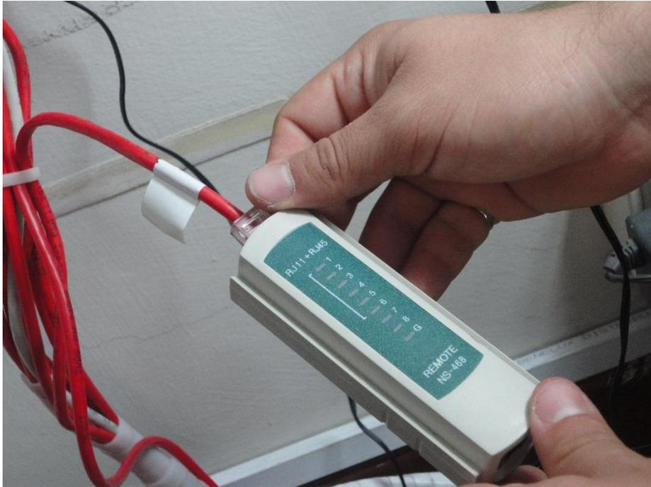
**APLICACIÓN DEL TESTEADOR DE CLAVES PARA LA VERIFICACION DEL CABLE DE RED**
