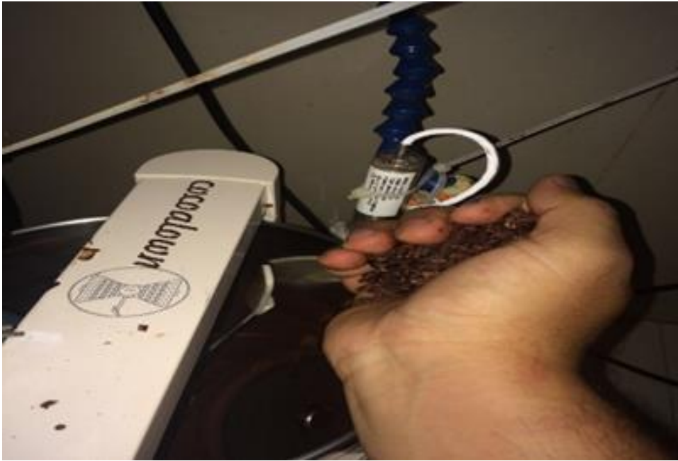
Anexo 5. Adición de los ingredientes en el conchador
