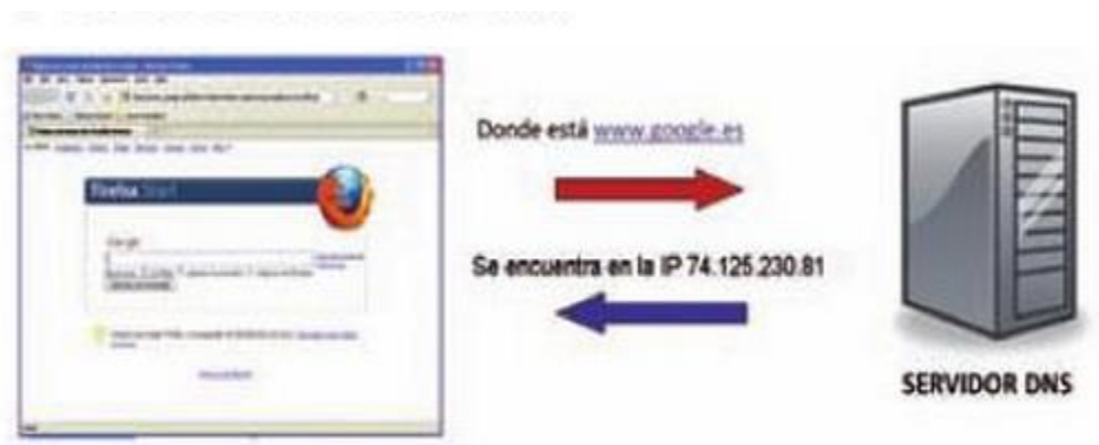
Figura 2.4. Búsqueda de la IP en el servidor DNS
