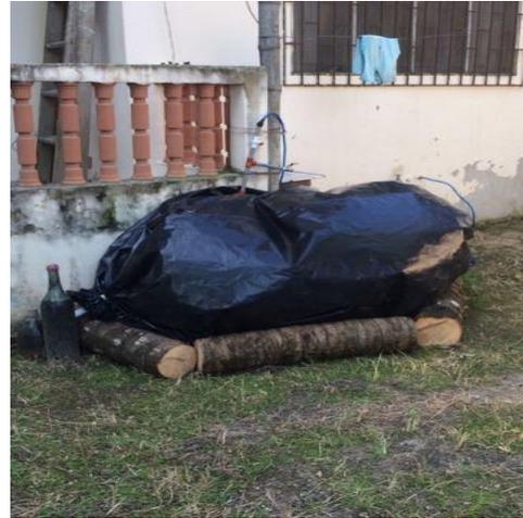
**2.6.** Biodigestor tubular de polietileno tipo salchicha.
