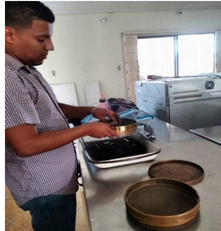
Anexo 2-H. Tamizando el Carbón activado
