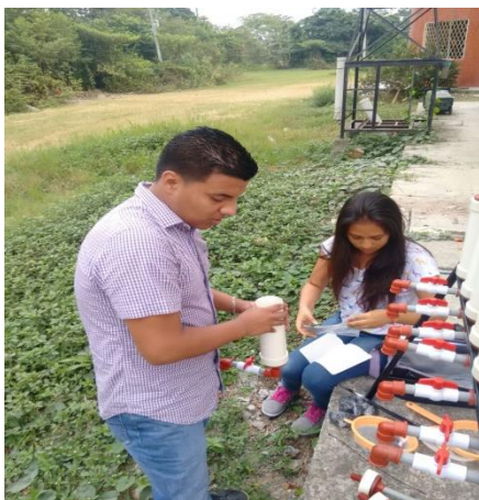
Anexo 4-C. Colocación del CA en los filtros
