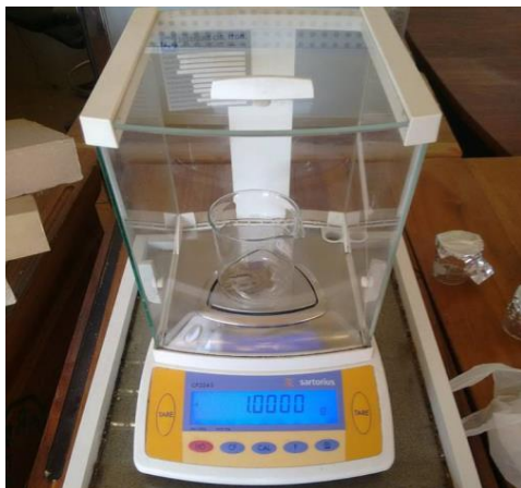
Anexo 5-C. Pesado del cloro
