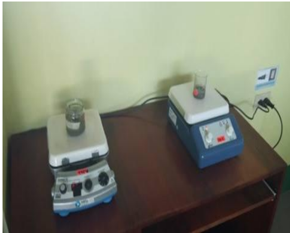
Anexo 3. I. Agitando la solución del suelo en el laboratorio de suelos de la ESPAM MFL.
