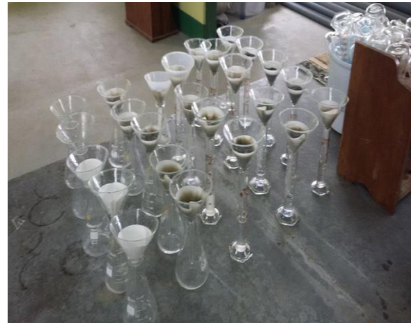
Anexo 3. J. Filtración de las muestras de suelo previamente agitadas en el laboratorio de suelos de la ESPAM MFL.
