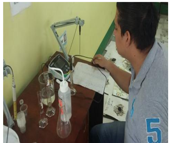
Anexo 3. L. Medición del pH de cada uno de los tratamientos en el laboratorio de suelo de la ESPAM MFL.
