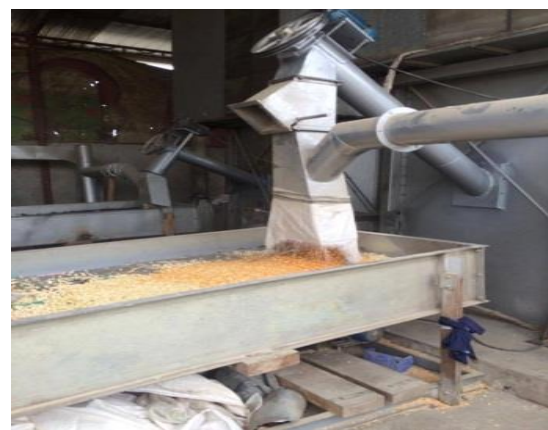
4.6. Procesamiento del maíz (Maquinaria desprotegida)
