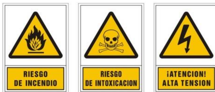
Figura 4. 3. Señales de Advertencia
