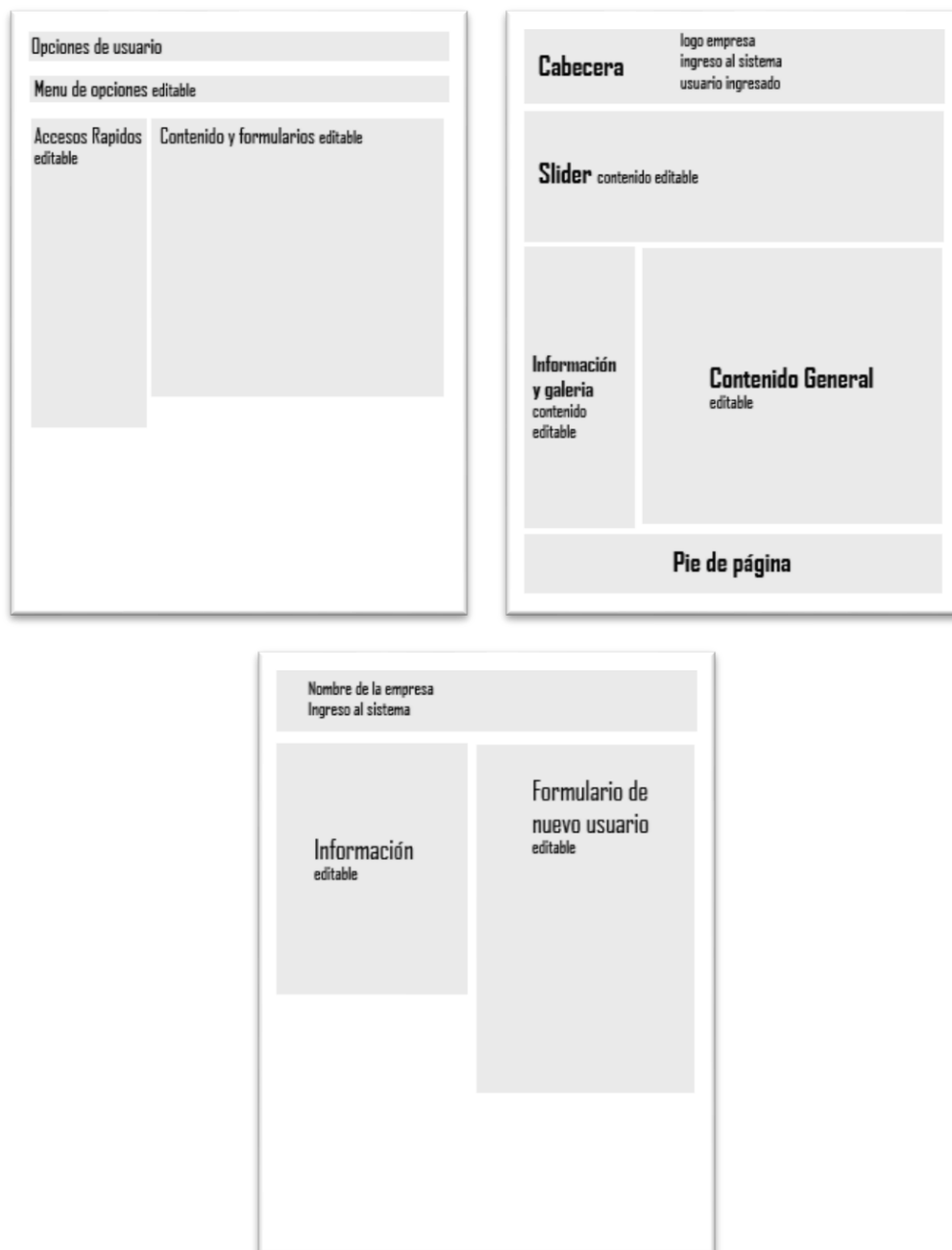
Figura 4. 2, Bosquejo y modelado de plantillas para paginas index, registro de usuario e interface de usuario.
