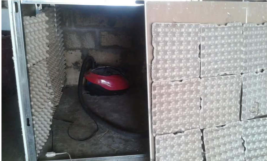
Foto 4.2 Resultado de la caja para prueba acústica
