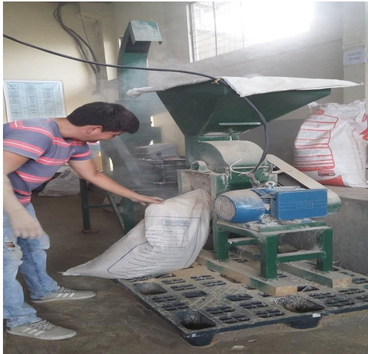
Foto. 3. Molienda de cascarilla de arroz
