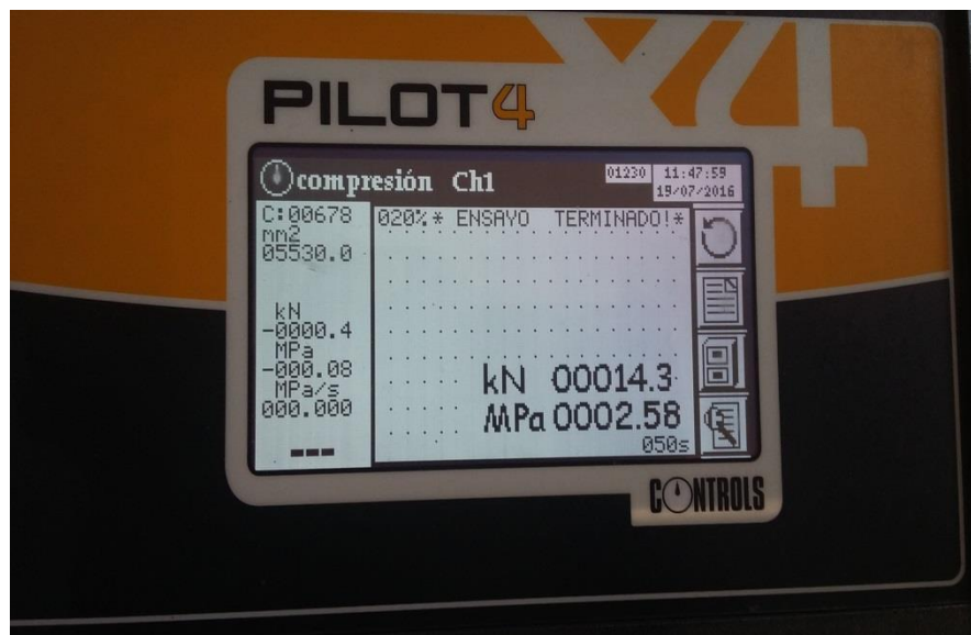
Foto 6. Resultado obtenido en máquina de compresión
