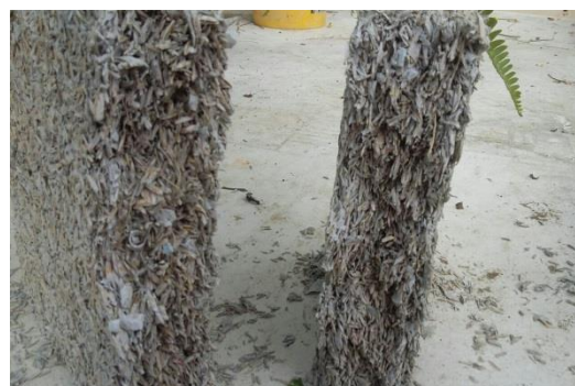
Foto 4.1 Muestras de Eco-bloques fallidos
