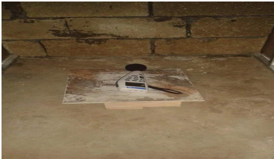
Foto 4.2 Forma de realización de la prueba acústica a través de sonómetro
