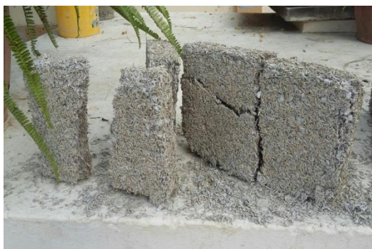
Foto 4.1 Muestras de Eco-bloques fallidos
