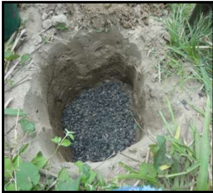
REALIZACIÓN DE CALICATA EN EL RÍO CARRIZAL
