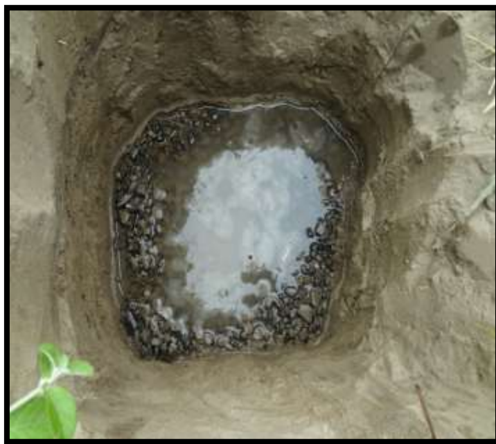
REALIZACIÓN DE CALICATA EN EL RÍO CARRIZAL
