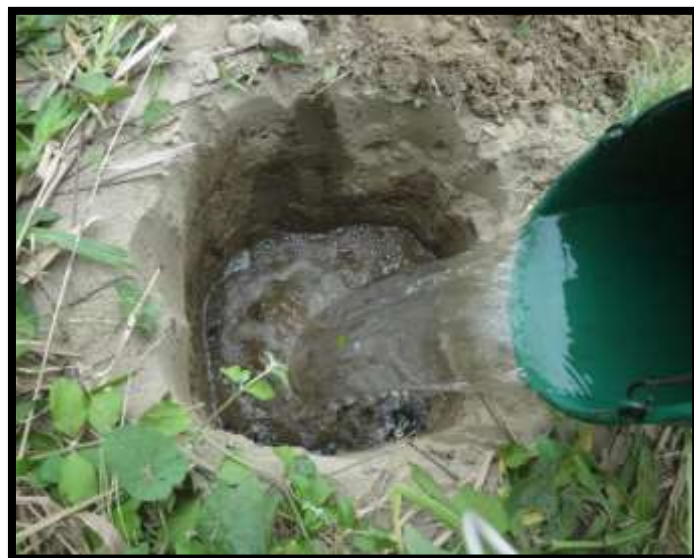
REALIZACIÓN DE CALICATA EN EL RÍO CARRIZAL
