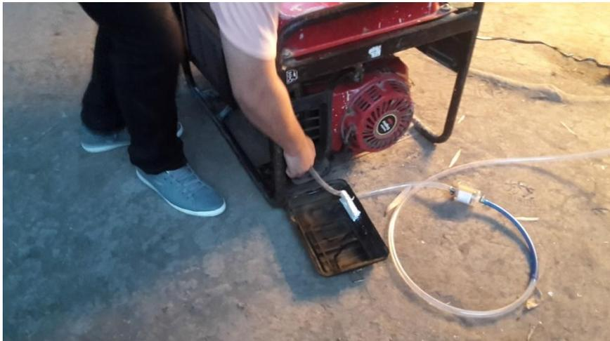
**Anexo 1. S.** Prueba del motor usando el biogás como combustible, con consumo energético.
