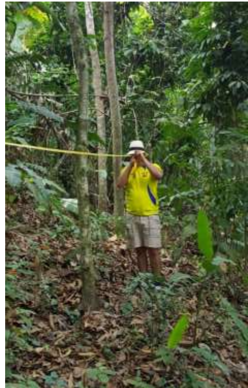
J) Toma de altura con el clinómetro
