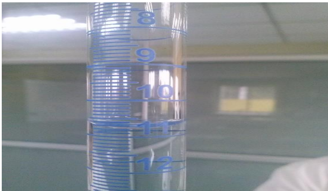
ANEXO 6. Lectura del consumo de hidróxido de Sodio para determinar la acidez
