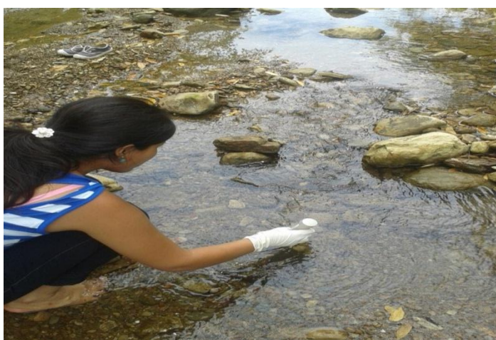
Foto 5. Toma de muestra en las escorrentías para análisis físicos
