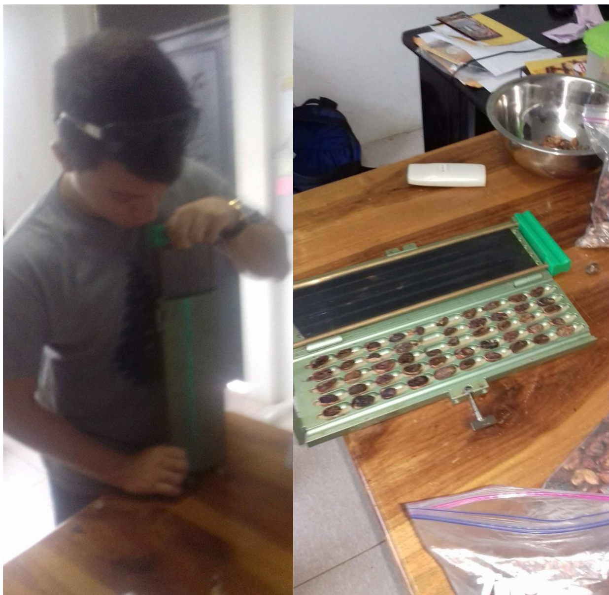
Figura 3.2. Prueba de corte con la guillotina para evaluar fermentacion
