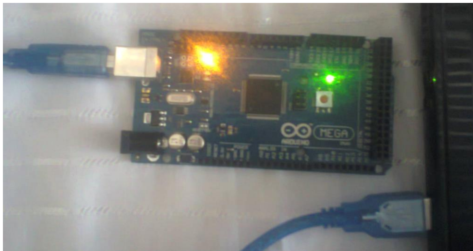
Foto 3.1. Ejecución del código blink en el Arduino Mega
