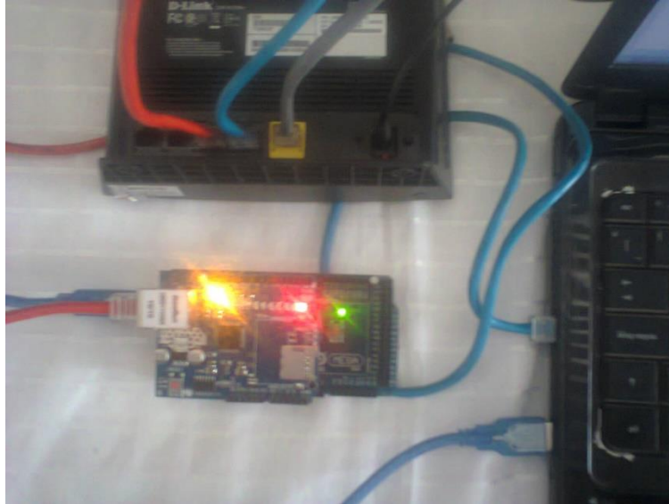
Foto 3.3. Conexión del Ethernet shield y servidor al router
