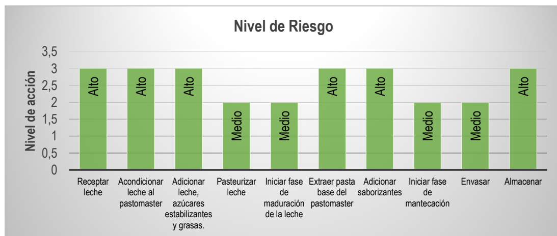
Gráfico 4.9. Nivel de riesgo según el método REBA de cada una de las actividades en el proceso de elaboración de helados.
