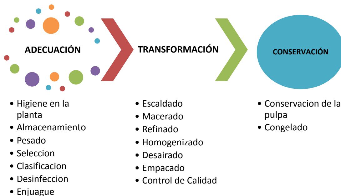
GRÁFICO 4.13.- OPERACIONES PARA LA OBTENCIÓN DE LA PULPA FUENTE: ELABORADO POR LAS AUTORAS
