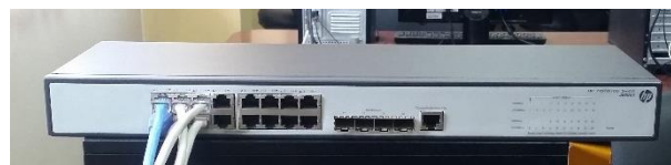
Foto 4. 5. Switch HP v1910-16g encargado de enviar la dirección e imagen del servidor a los clientes
