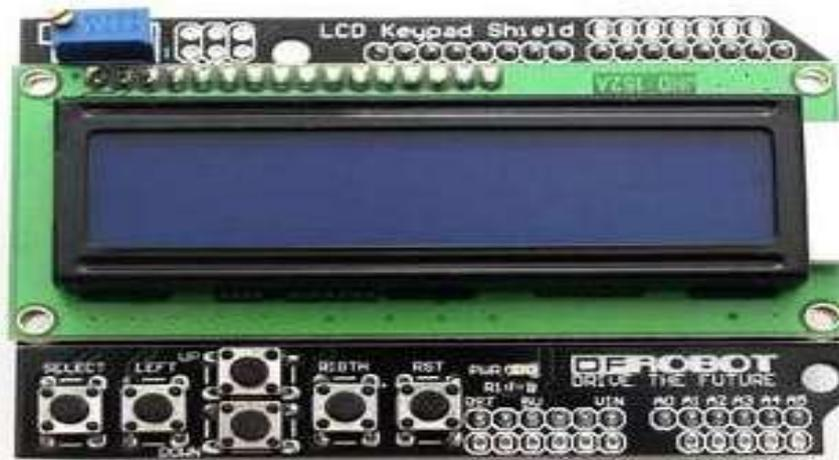
**Figura 2. 4** Pantalla Lcd para Arduino 16x2 Fuente Arduino (2013)
