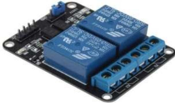
Figura 2. 6 Relé 2 canales 5v Arduino
