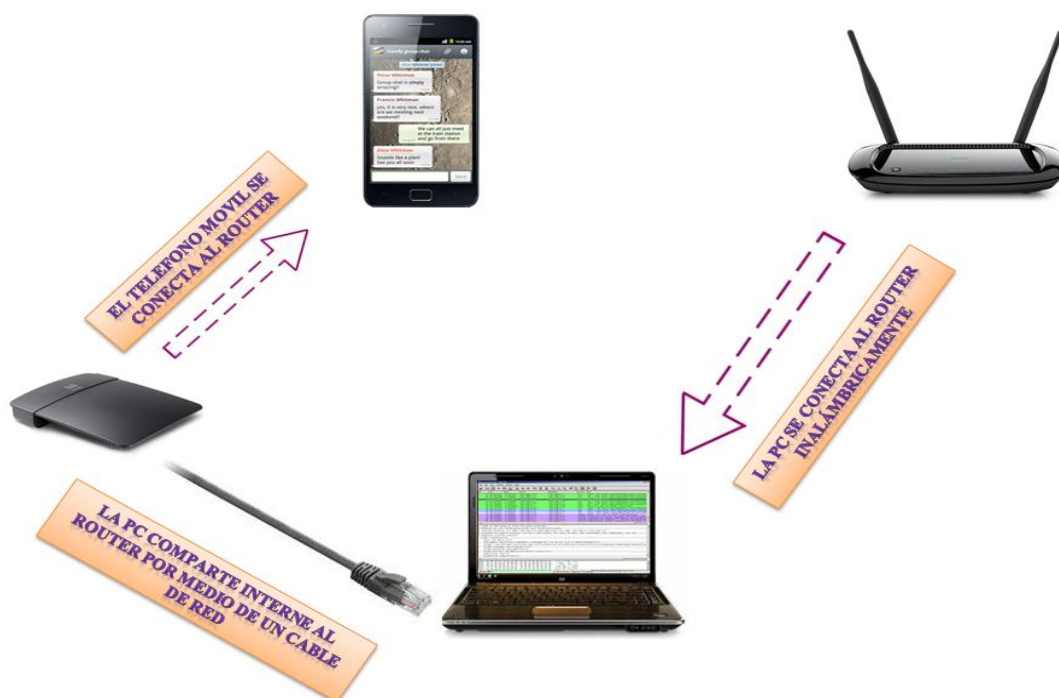
Imagen 3.9. Creación de un Acces Point en que la computadora funciona como un host Elaboración: Los Autores
