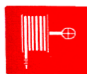
Manguera para incendios
