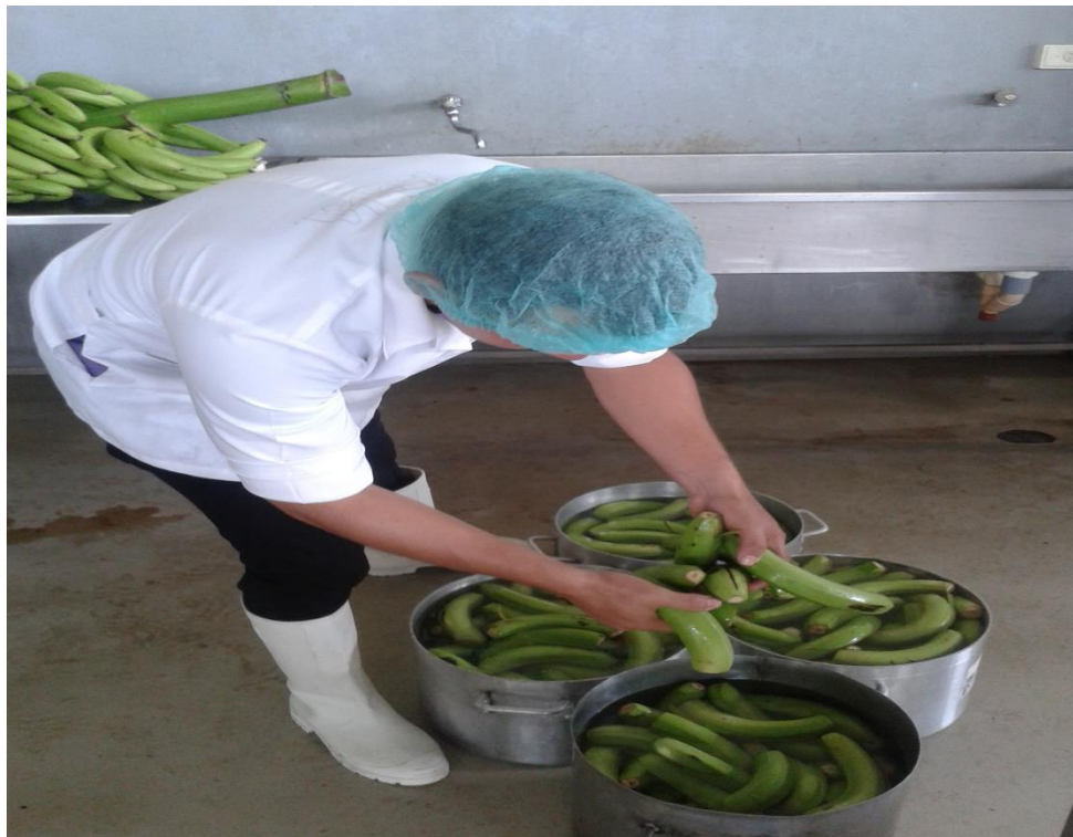
Anexo N.º 12. Inmersión de la materia prima a la solución de hipoclorito de sodio.
