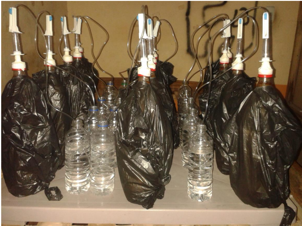
Anexo N.º 17. Ensamblaje de las magueras y envases con agua para la expulsión de gases.
