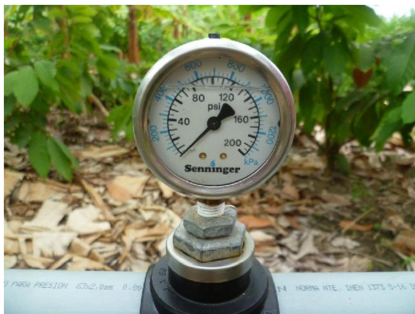
Manómetro que regula la presión de entrada.
