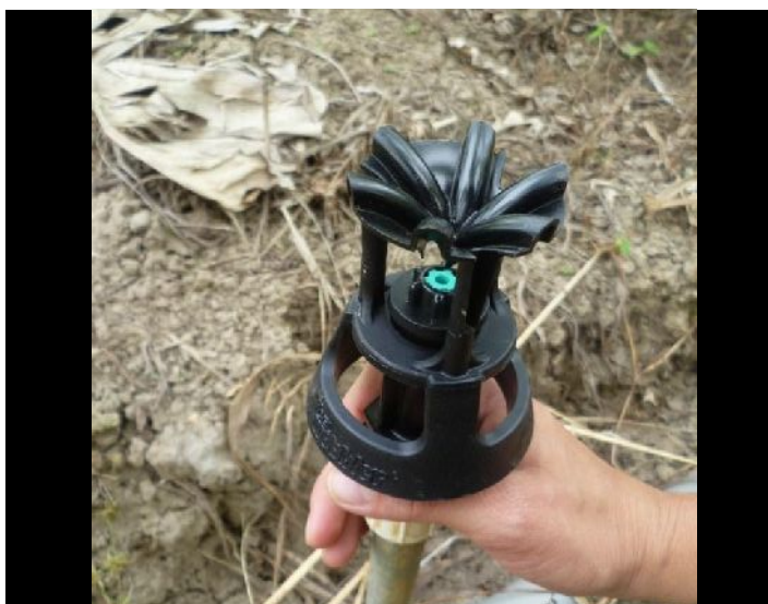
El aspersor utilizado para la evaluación.
