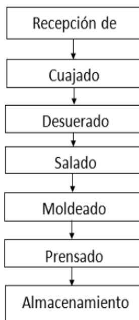
Figura 2.1. Diagrama básico de bloque de elaboración de queso artesanal manaba. Fuente. Arteaga et al. (2019).
