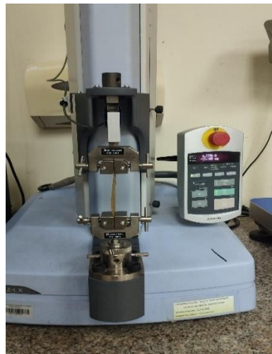
Anexo 6-B. Medición de la resistencia a la tensión y elongación
