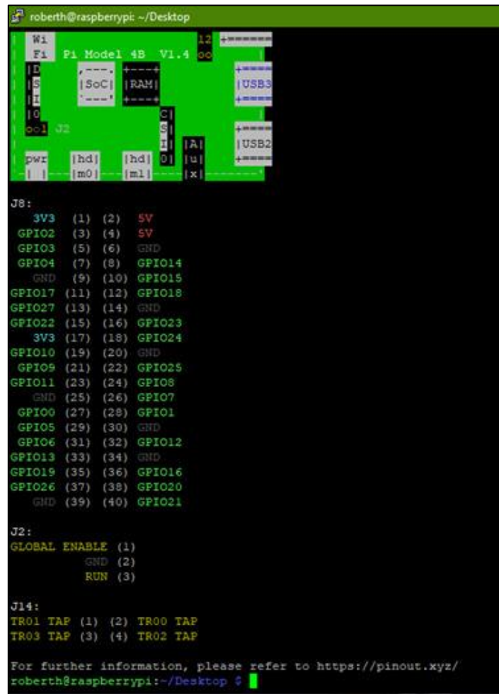
Ilustración 2. Pines GPIO de la Raspberry pi
