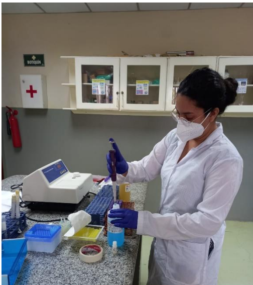
Anexo 3C: Aplicación del reactivo de proteína y albúmina en las muestras
