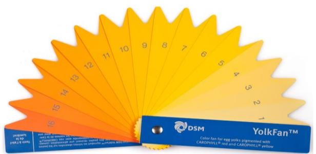
**Figura 1.** Abanico colorimétrico DSM YolkFan™..
