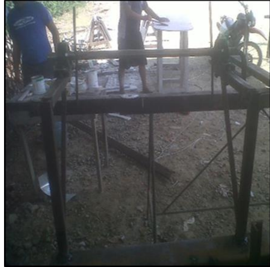
Foto N° 2. Estructura del medidor de sedimentos.
