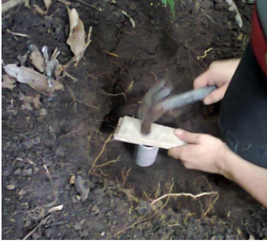
Toma de muestra para densidad aparente Cilindro de 125 cc
