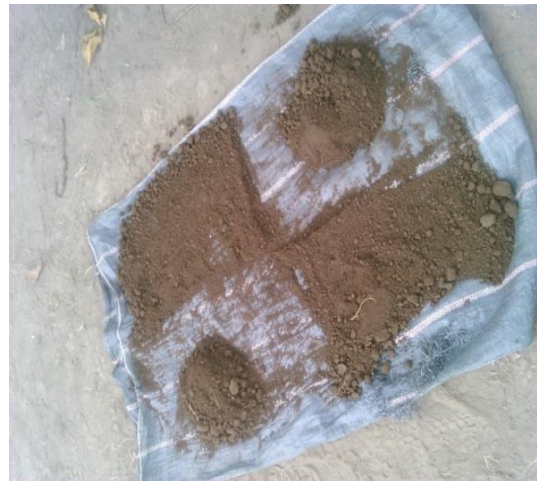
Técnica del cuarteo para selección de la muestra compuesta
