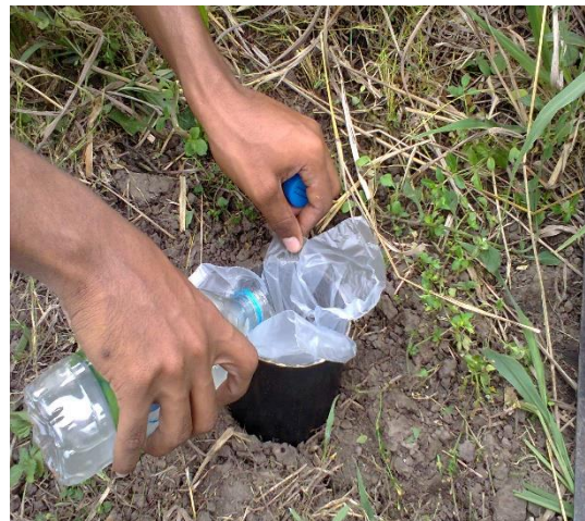
Ensayo de infiltración in situ Método del cilindro simple
