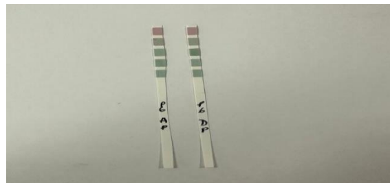
Foto 4. Determinación de pH, muestras de agua antes y después del Pasivo 6, P6, efluente de ganadería
