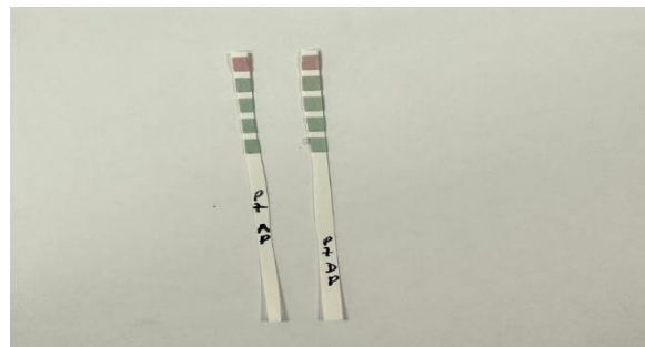
Foto 5. Determinación de pH, muestras de agua antes y después del Pasivo 7, P7, camaroneras
