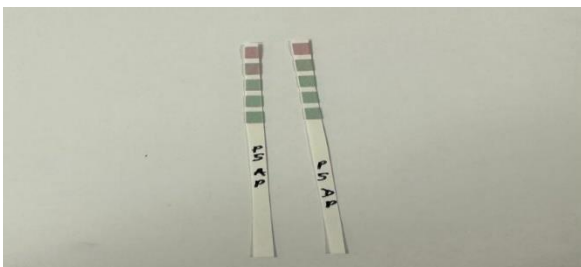
Foto 3. Determinación de pH, muestras de agua antes y después del Pasivo 5, P5, Efluente tubería de acero
