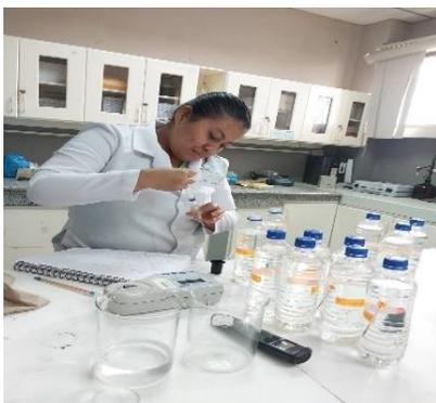
**3.C.-** Etiquetado y muestreo de tratamientos fisicoquímicos analizados de agua del rio Carrizal.
