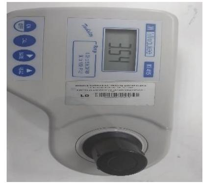
**3.I.**- Resultado del parámetro de turbidez en el turbidímetro de la muestra de agua del rio Carrizal.
