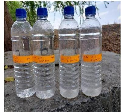
**3.C.-** Etiquetado y muestreo de tratamientos fisicoquímicos analizados de agua del rio Carrizal.
