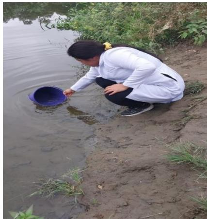
**2.B.-** Colecta de muestra de agua del Río Carrizal en un balde de 12 litros.
