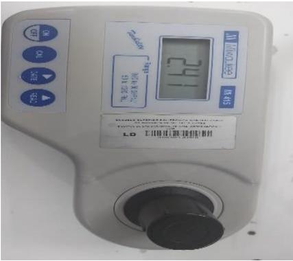
**3.G.**-Resultado del parámetro de turbidez en el turbidímetro de la muestra de agua del rio Carrizal.
