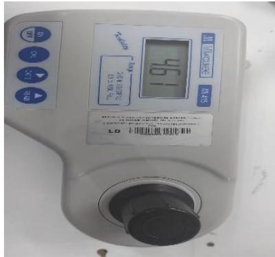
**3.H.**- Resultado del parámetro de turbidez en el turbidímetro de la muestra de agua del rio Carrizal.
