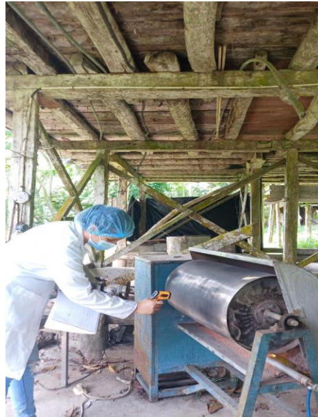
Anexo 3-b. Registro de la temperatura del proceso
