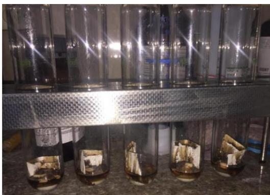
**ANEXO 9-D.** Digestión de las muestras en el equipo Digestor Kjeldahl
