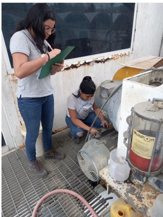
Fotografía 7. Toma de datos de vibraciones
