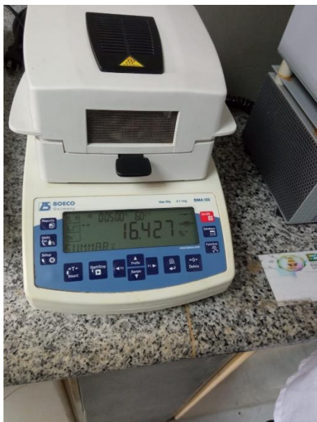
Anexo 5. Medición de humedad
