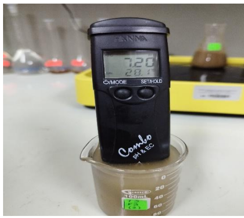
Fotografía 12.- Determinación de pH
