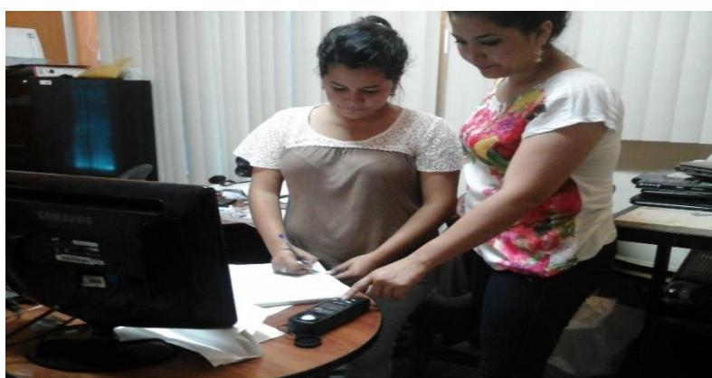
Anexo 6 –A; medición de iluminación en el área administrativa punto 1
